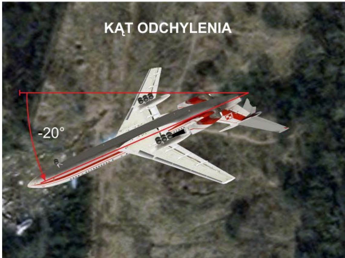
Rys. 17. Kąt odchylenia w momencie zderzenia z ziemią
