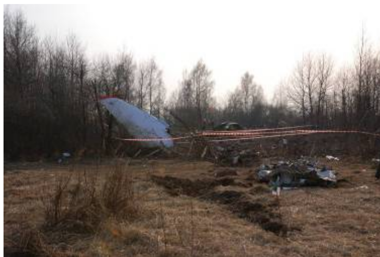
Rys. 12. Ślad na ziemi spowodowany lewym sterem kierunku
