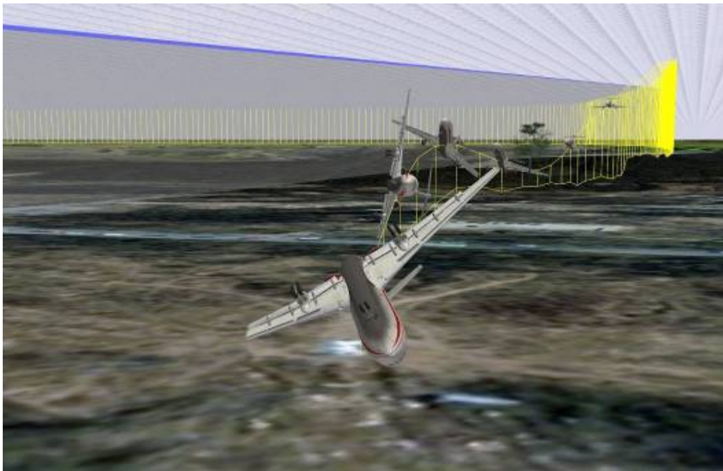
Rys. 13. Graficzne przedstawienie ostatniej fazy lotu i zderzenia z ziemią (widok od strony nalotu samolotu)
