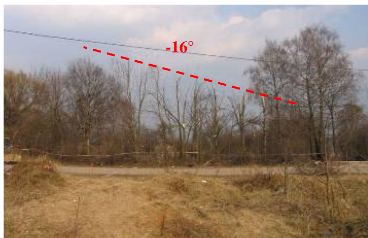
Rys. 8. Uszkodzone drzewa (punkt 6 rys. 2) przez skrzydła i kadłub samolotu przy przechyleniu około -16^\circ (w lewo)
