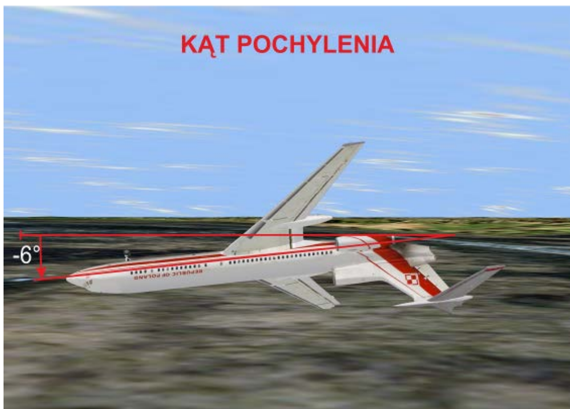
Rys. 16. Kąt pochylenia w momencie zderzenia z ziemią
