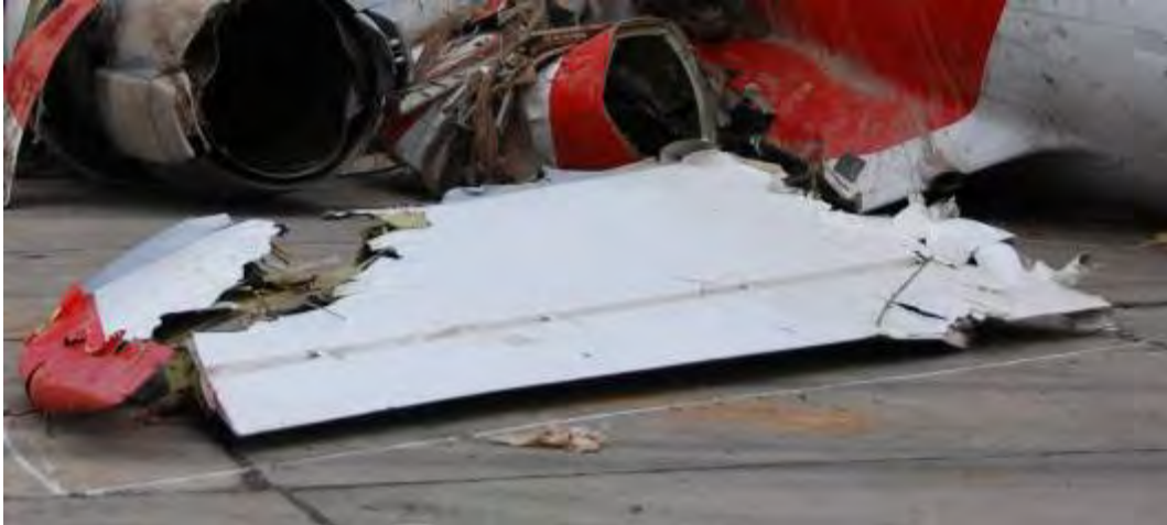
Rys. 21. Lewa część statecznika poziomego ze sterem wysokości
