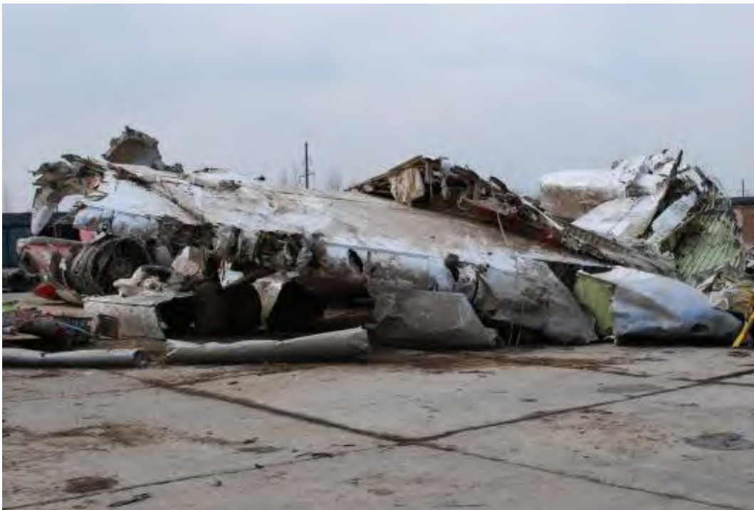
Rys. 14. Krawędź natarcia przykadłubowej części prawego skrzydła
