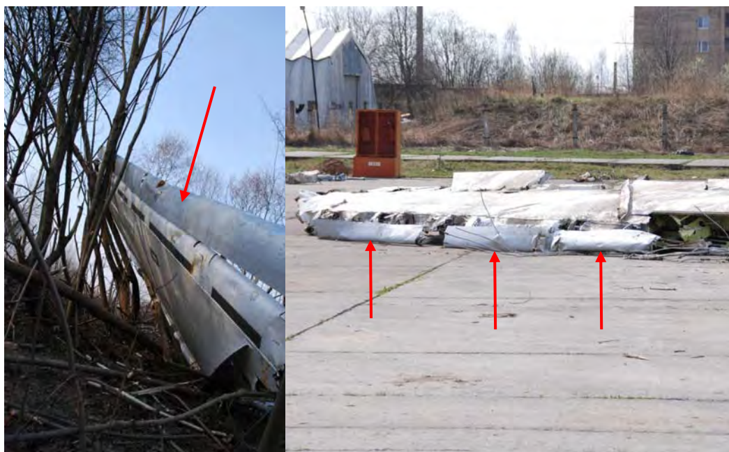
Rys. 7. Wypuszczone sloty lewego i prawego skrzydła samolotu
