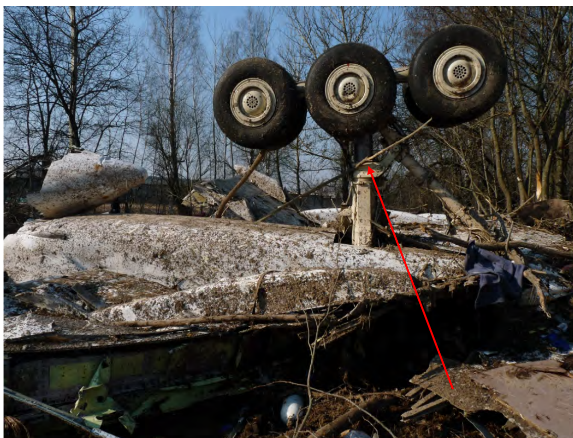
Rys. 12. Wypuszczona prawa goleń podwozia głównego
