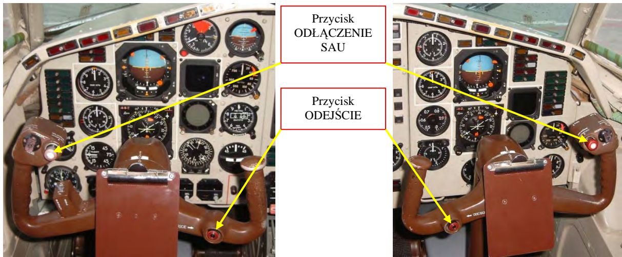
Rys. 12. Rozmieszczenie przycisków sterowania SAU na wolantach
