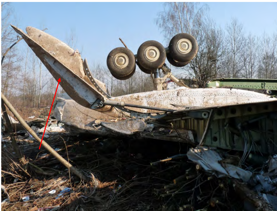
Rys. 8. Wychylone kłapy zaskrzydłowe
