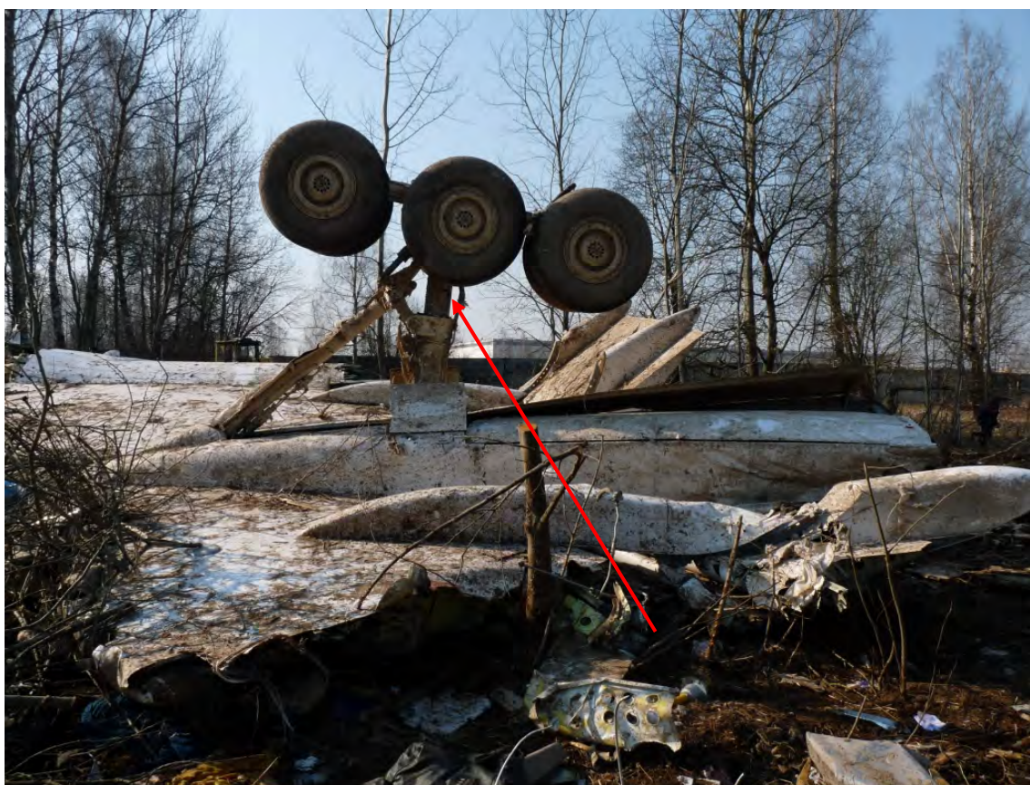
Rys. 12. Wypuszczona prawa goleń podwozia głównego
