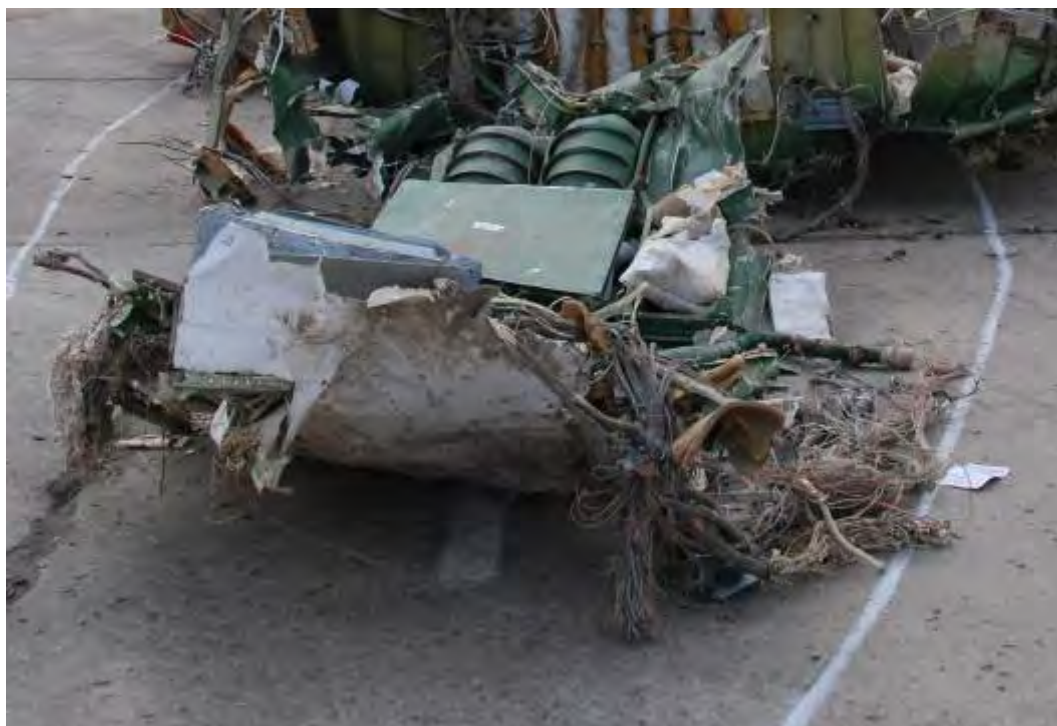
Rys. 7. Pozostałości przedniej części samolotu
