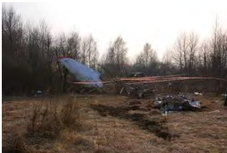
Rys. 12. Ślad na ziemi spowodowany lewym sterem kierunku
