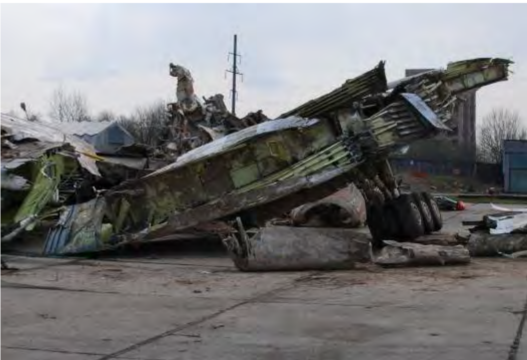
Rys. 16. Rozerwana krawędź natarcia lewego skrzydła
