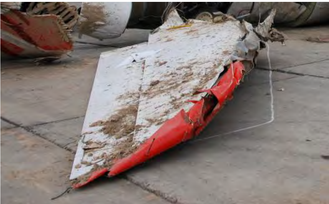
Rys. 20. Prawa część statecznika poziomego ze sterem wysokości
