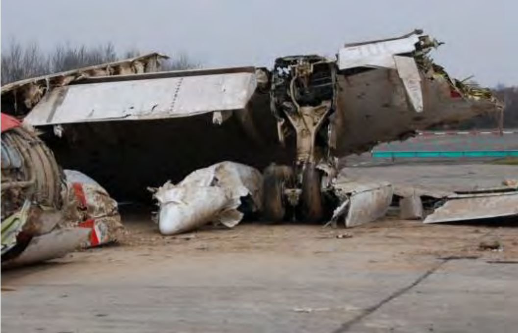
Rys. 15. Krawędź splywu prawego skrzydła oraz prawe podwozie główne
