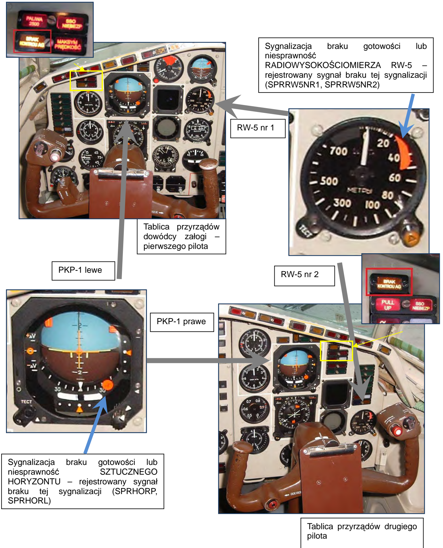
Rys. 26. Sygnalizacja braku gotowości lub niesprawność SZTUCZNEGO HORYZONTU oraz braku gotowości lub niesprawność RADIOWYSOKOŚCIOMIERZA RW-5 na prawej i lewej tablicy przyrządów oraz sygnalizacja BRAK KONTROLI AG
