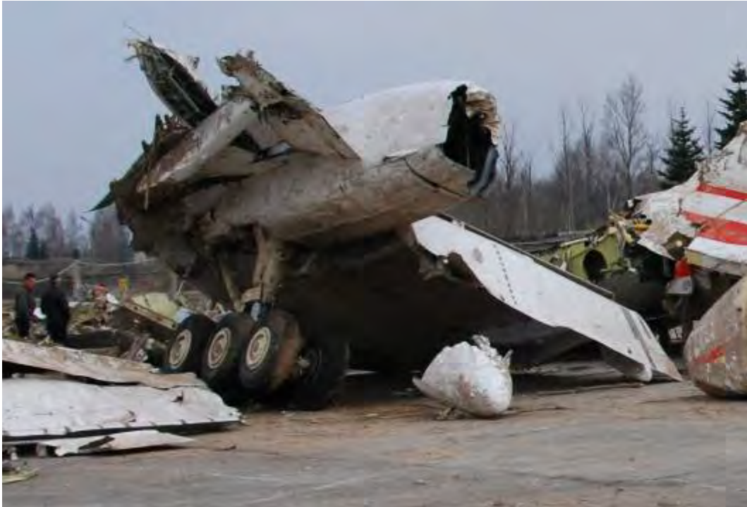
Rys.17. Krawędź spływu lewego skrzydła oraz lewe podwozie główne
