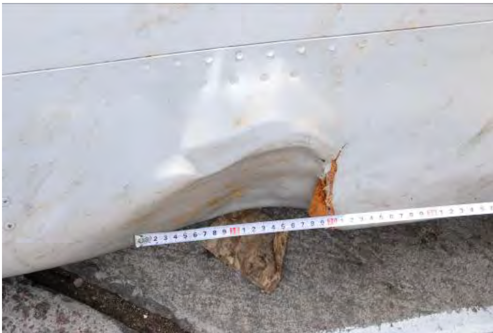
Rys. 3. Charakterystyczne owalne wgniecenia na krawędzi natarcia skrzydeł
