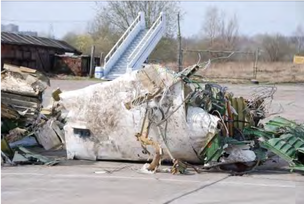
Rys. 8. Fragment kadłuba w miejscu mocowania przedniej nogi podwozia
