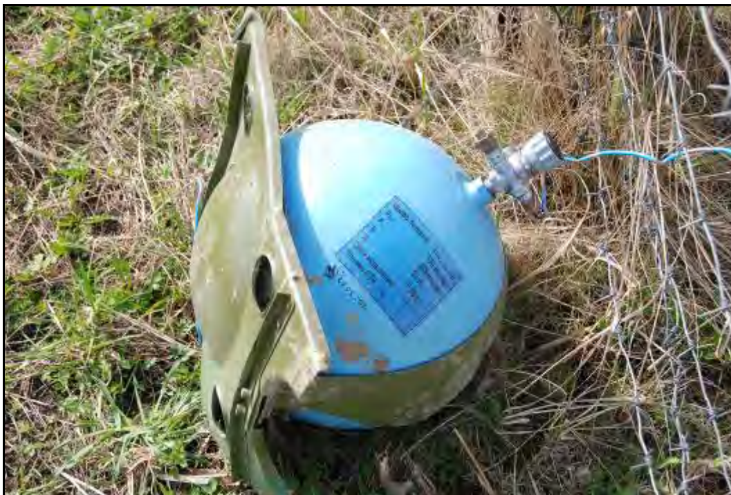
Rys. 32. Butla УБШ-25/150М wraz z częścią podstawy i przewodami tlenowymi
