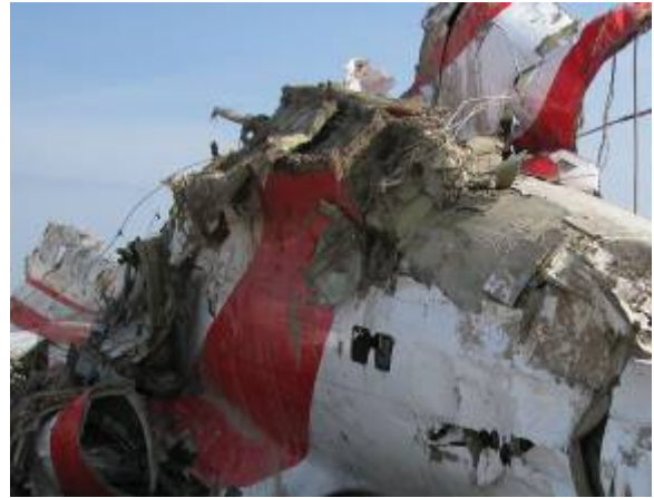
Zdj. 42. Widok kadłuba – miejsce zabudowy statecznika i wlotu do silnika nr 2
