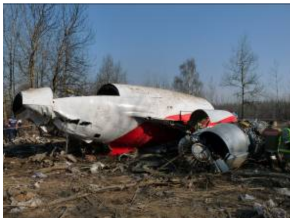
Zdj. 29. Widok kadłuba z zabudowanym silnikiem nr 2 (środkowy)
