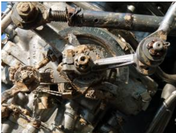
Zdj. 19. Widok agregatów silnikowych oraz elementów sterowania silnikiem – noniusz na pompie NR-30KU-4
