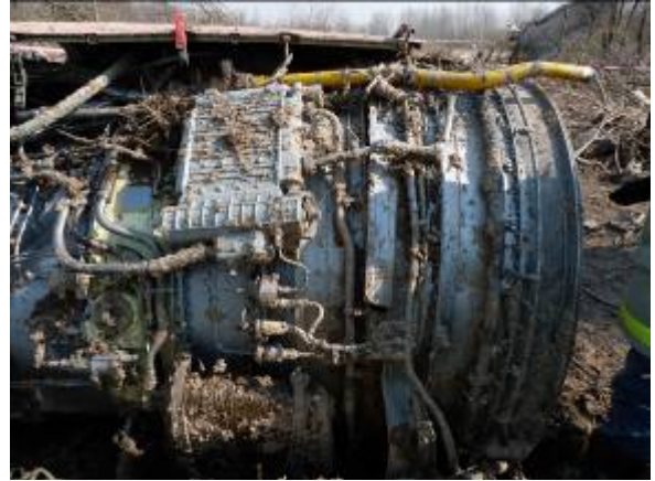
Zdj. 50. Widok agregatów silnikowych oraz elementów sterowania silnikiem po zdjęciu osłon (strona lewa silnika)
