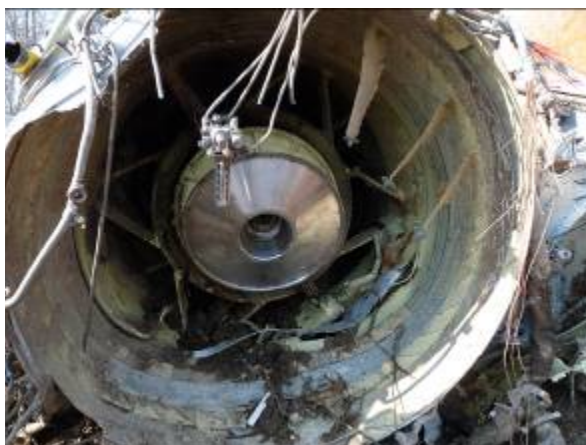
Zdj. 5. Widok stanu sprężarki niskiego ciśnienia
