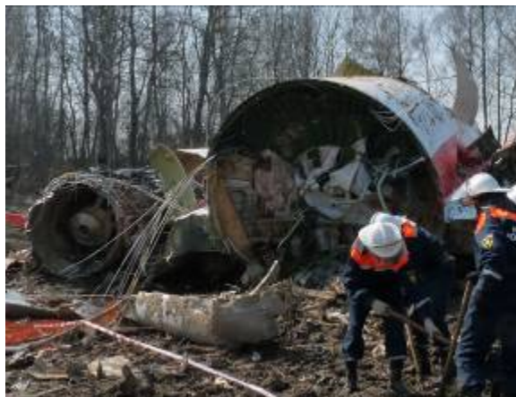
Zdj. 4. Widok silnika od strony wlotu
