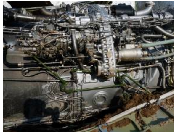
Zdj. 12. Widok agregatów silnikowych oraz elementów sterowania silnikiem po zdjęciu osłon
