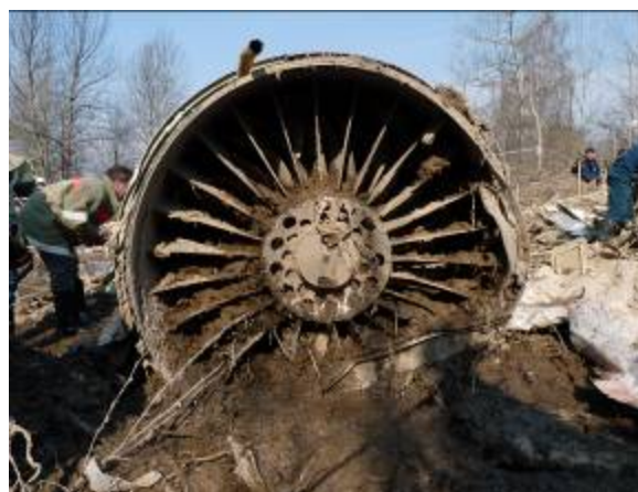
Zdj. 46. Widok łopatek wlotowego AK SNC
