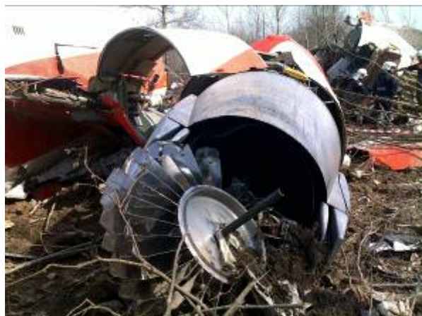
Zdj. 23. Widok dyszy wylotowej silnika oraz tarczy z łopatkami wirnika I st. SNC
