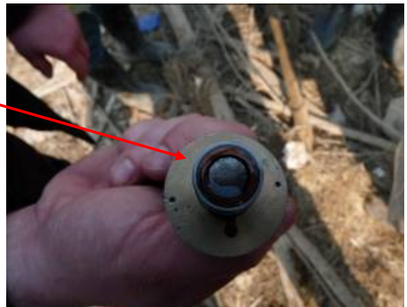
Zdj. 40. Korek magnetyczny zabudowany na pompie odsysającej MNO-30K
