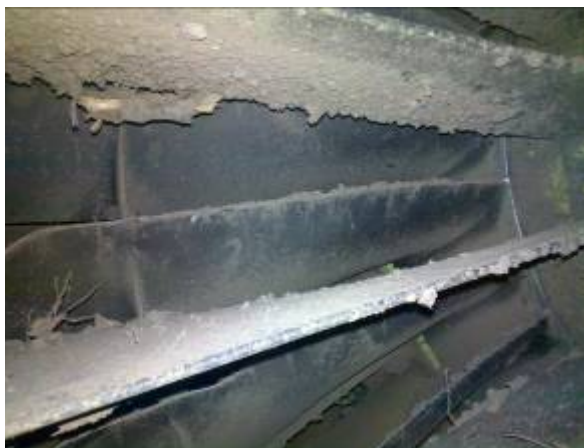
Zdj. 7. Widok uszkodzeń na krawędziach natarcia łopatek I st. SNC
