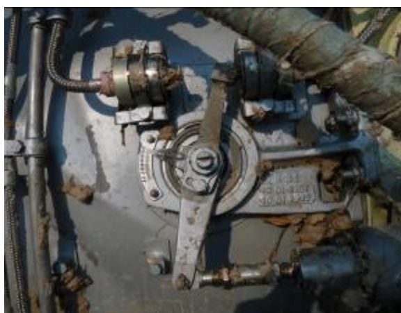
Zdj. 28. Noniusz ustawienia łopatek wlotowych AK SWC
