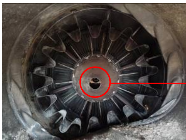
Zdj. 31. Widok ostatniego stopnia turbiny niskiego ciśnienia i mieszalnika
