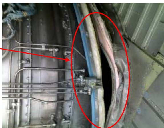
Zdj. 2. Deformacja kołnierza na połączeniu korpusu wlotowego silnika z elementami płatowca
