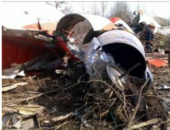
Zdj. 2. Widok silnika od strony dyszy z jego tarczą wirnika I st. sprężarki niskiego ciśnienia
