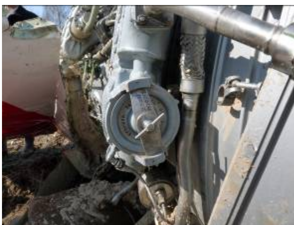
Zdj. 21. Widok filtra na chłodnicy paliwowo-olejowej
