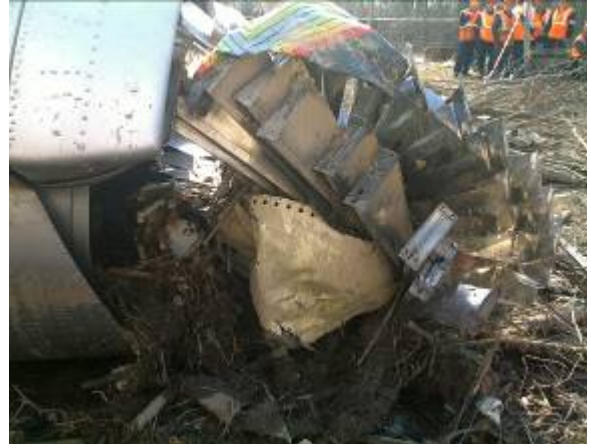
Zdj. 8. Tarcza z łopatkami roboczymi i łopatki aparatu kierującego SNC
