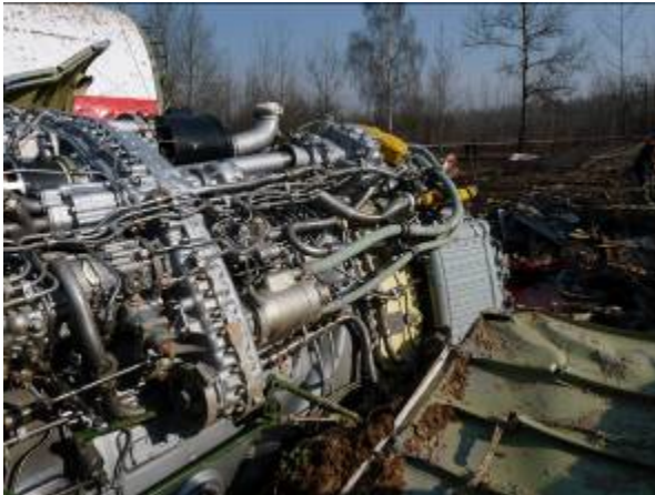
Zdj. 11. Widok agregatów silnikowych oraz elementów sterowania silnikiem po zdjęciu osłon
