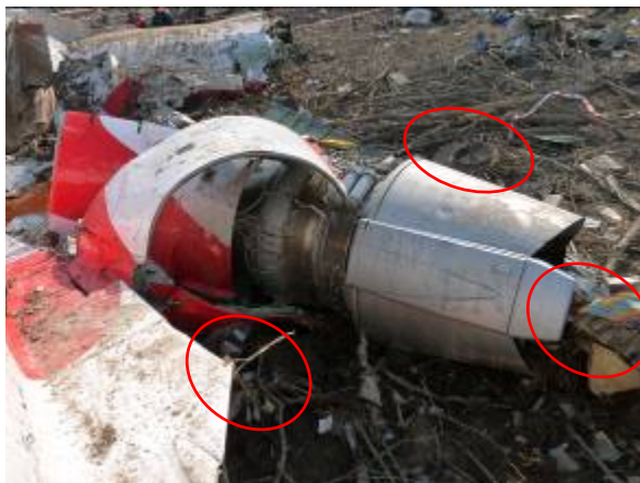
Zdj. 3. Widok silnika z jego prawej strony oraz tarcz z łopatkami SNC
