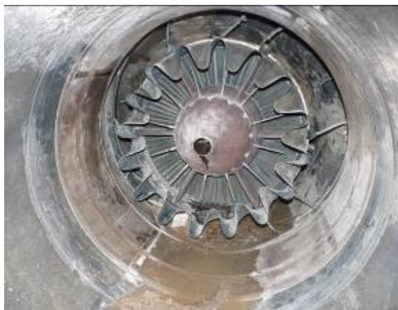
Zdj. 24. Widok ostatniego stopnia wirnika turbiny niskiego ciśnienia i mieszalnika
