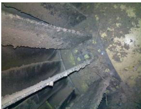
Zdj. 5. Widok zanieczyszczonego wnętrza korpusu wlotowego silnika i łopatek AK I st. SNC
