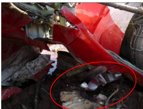
Zdj. 27. Widok tarcz z łopatkami SNC oraz łopatki AK silnika
