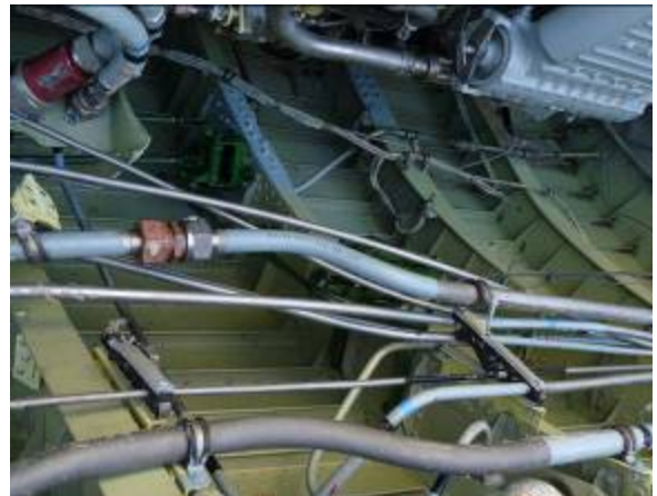
Zdj. 38. Widok elementów sterowania silnikiem
