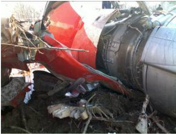
Zdj. 9. Widok silnika z jego prawej strony oraz tarczy z łopatkami SNC
