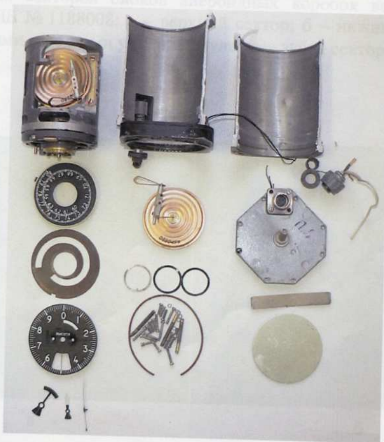
Рисунок 1.6 – Вид узлов anerоидных коробок высотомера ВМ-15ПБ № 1188008: а – после демонтажа задней крышки (стрелками указаны секторы, вышедшие из зацепления с центральной трибкой); б – после частичного препарирования прибора
