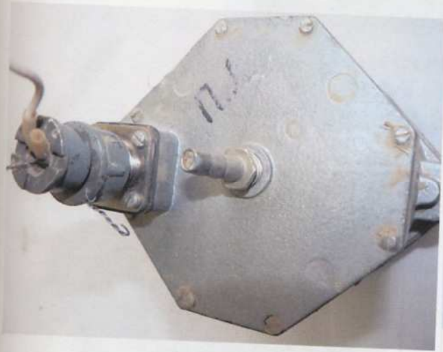
Рисунок 1.3 - Масляные пломбы с литерой «А» на головках винтов крепления: а - задней крышки; б - фланца
