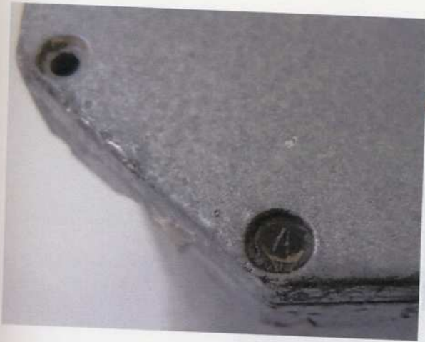
Рисунок 1.3 - Масляные пломбы с литерой «А» на головках винтов крепления: а - задней крышки; б - фланца
