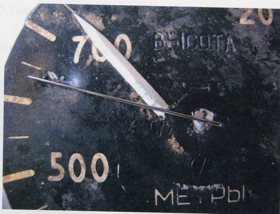
Рисунок № 2.28 – Реконструкция взаимного положения шкалы и стрелки указателя
