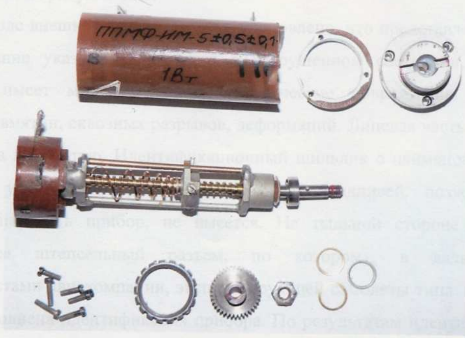
Рисунок 1.21 – Вид потенциометра ППМФ-ИМ-5±0,5±0,1-2 после его частичной разборки
